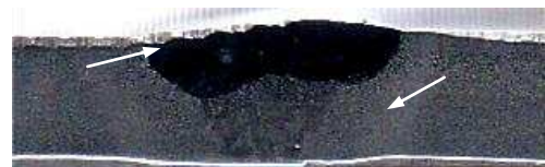
Gambar 8. Daerah Root Pass , Cover Pass dan HAZ
