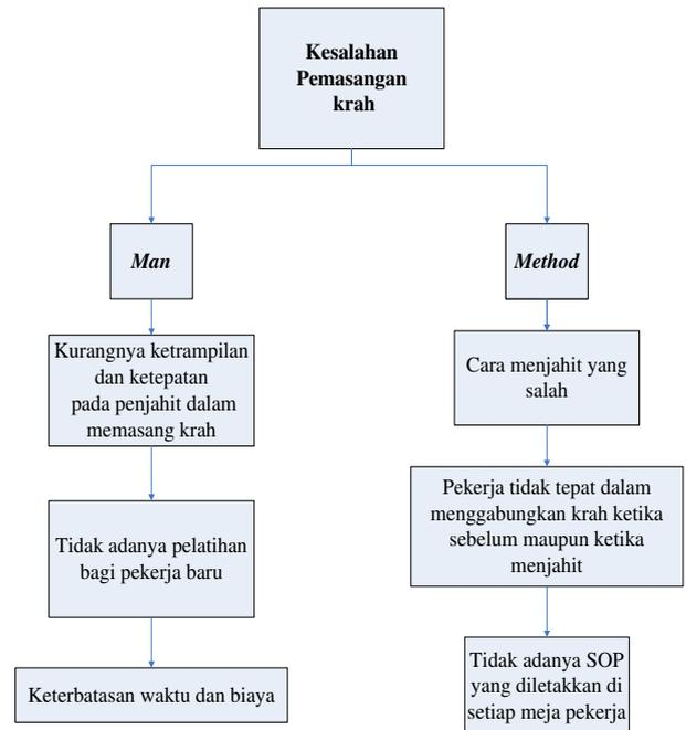
Gambar 5. Root Cause Analysis Kesalahan Pemasangan Krah
