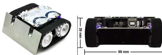
Gambar 1. Perspektif zumo robot dengan arduino pada bagian atas; dimensi lebar dan tinggi robot
