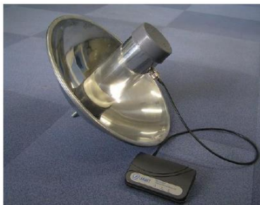
Gambar 3. Antena Wajan Bolic yang sudah dirakit
