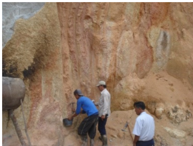
Gambar 2. Metode Pengambilan Sampel Mineral Berat secara Channel Sampling .
