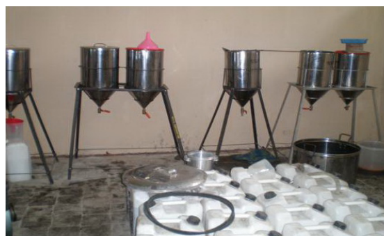
Gambar 2. Tabung Pemurnian Minyak Kelapa
