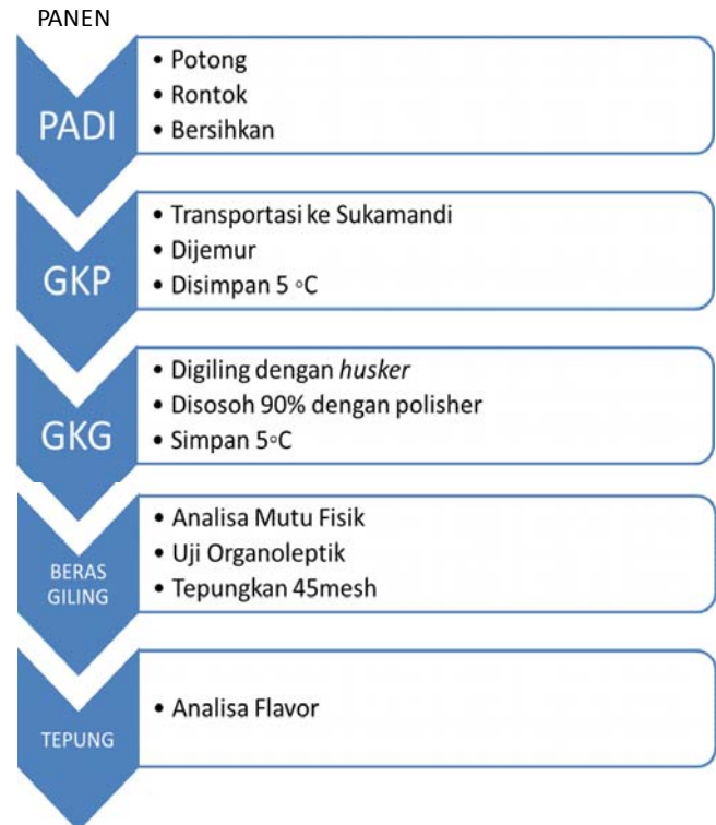
Gambar 1. Alur kerja dari panen padi sampai dengan penepungan beras.
