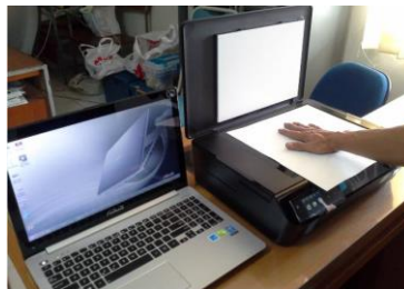
Gambar 3. Cara pengambilan citra permukaan tangan subyek menggunakan TLC dan Scanner
