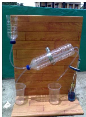
**Gambar 1.** Alat Destilasi Sederhana
