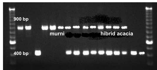
Gambar 7. Pola pita hasil elektroforesis gel menggunakan agarose 1,2% dengan pewarnaan menggunakan ethidium bromide dengan primer R01. Pita dengan ukuran 400 pb adalah A. auriculiformis , 900 pb adalah A. mangium , dan pita dengan ukuran 400 pb dan 900 pb adalah hibrid Acacia (Sunarti, 2007).
