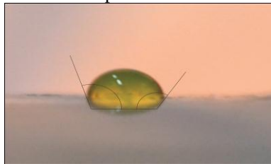
Gambar 9 Pemotretan sudut kontak pada arester polimer
