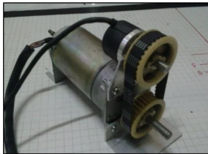
Gambar 10. Motor DC terhubung dengan sensor rotary encoder
