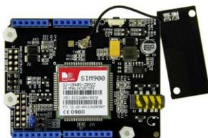
Gambar 3. Bentuk fisik GPRS Shield
