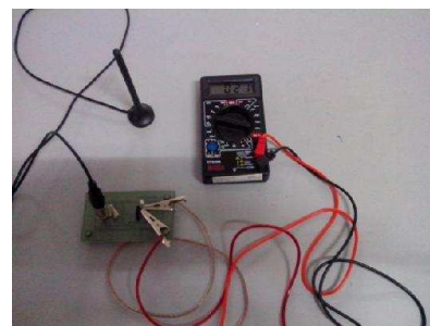
Gambar 11. Foto pengujian rangkaian rectifier dengan antenna indoor
