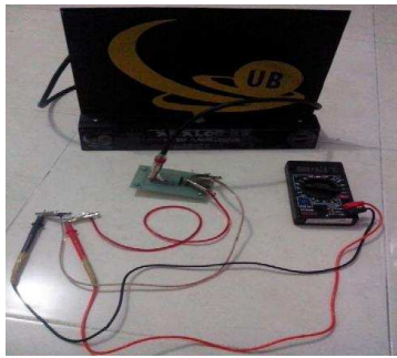
Gambar 15. Foto pengujian rangkaian rectifier dengan antena planar logo UB
