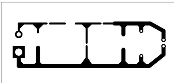
Gambar 9. Jalur *Footprint* rangkaian *Rectifier* (perancangan)
