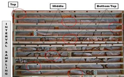
**Gambar 9.** Titik-titik pengukuran sampel
