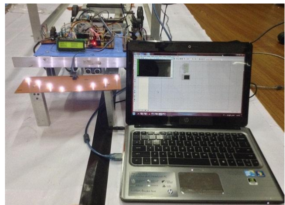
Gambar 11 Rangkaian Pengujian Sensor Photodioda
