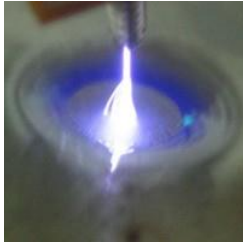
Gambar 3.9 Bentuk korona dari tegangan tinggi
