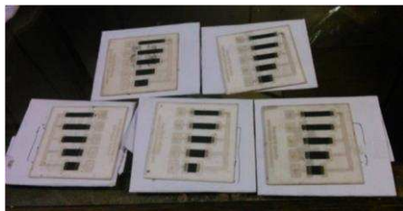
Gambar 9 . Resistor Hasil Proses Film Tebal Pada Keseluruhan Substrat
