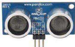
Gambar 6. Sensor Ultrasonik PING))
