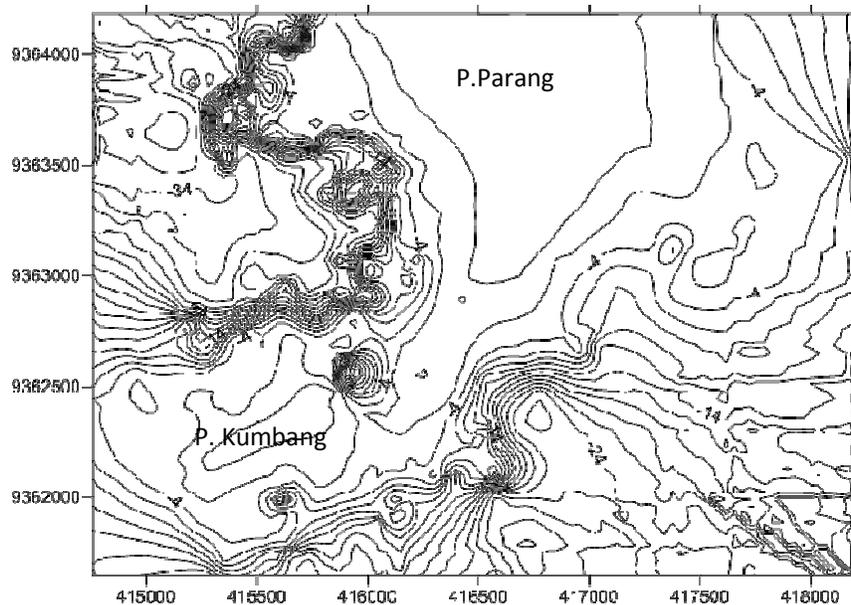
**Gambar 3.** Hasil pengukuran echosounder batimetri 2D pada Pulau Parang dan Pulau Kumbang penggambaran menggunakan Surfer 9.
