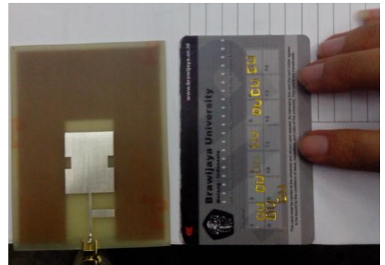
Gambar 5 Antena pengukuran yang dibandingkan besarnya dengan KTM (55x80 mm)
