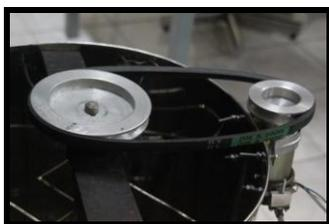
Gambar 8 Pemasangan Motor DC pada Alat Ekstraksi
