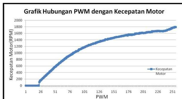
Gambar 15 Grafik Hubungan PWM dengan Kecepatan Motor
