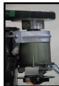
Gambar 1 Pemasangan motor DC pada alat ekstraksi
