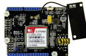
Gambar 3. Bentuk fisik GPRS Shield Sumber: seeedstudio.com/wiki/GPRS_Shield_V2.0
