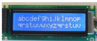
Gambar 6. Bentuk modul LCD 2x16 karakter
