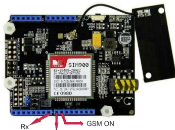
Gambar 11. Koneksi pin GPRS Shield dengan Arduino
