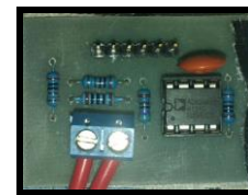
Gambar 11. Modul Rangkaian Pengondisi Sinyal PT100
