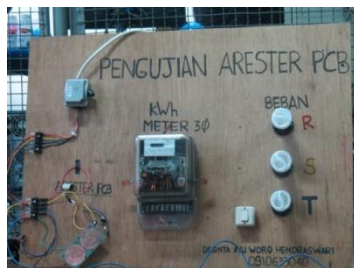
Gambar 11 Pengujian arrester PCB Sumber : Perancangan
