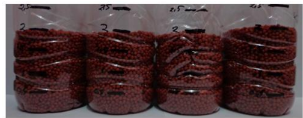
Gambar 15. Hasil keluaran pellet dari masing – masing pipa keluaran dengan takaran 200 gram.
