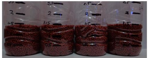
Gambar 14. Hasil keluaran pellet dari masing – masing pipa keluaran dengan takaran 150 gram.
