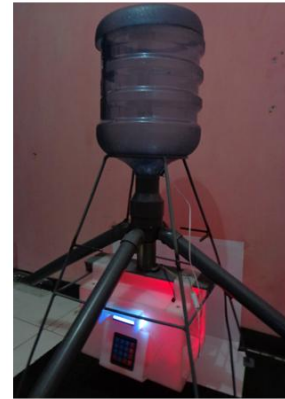
Gambar 2. Bentuk dan Tata Letak Alat Pemberi Makan Ikan Nila di Tambak (Tampak Depan)
