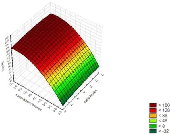
**Gambar 4.1** Hubungan Stabilitas dengan Kadar Asbuton dan Kadar Bahan Peremaja (0:100).
