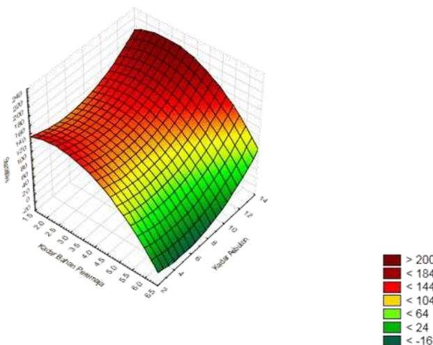
**Gambar 4.3** Hubungan Stabilitas dengan Kadar Asbuton dan Kadar Bahan Peremaja (50:50).
