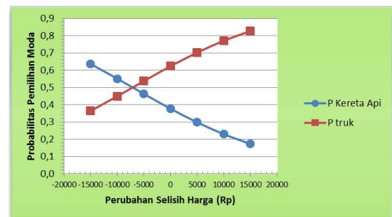
Gambar 6. Grafik Model Pemilihan Moda Berdasar Selisih Biaya Pengiriman Barang Elektronik ( \Delta X_1 ).
