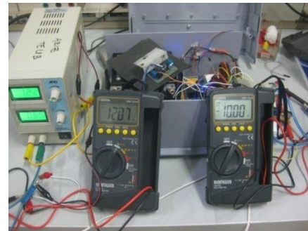
Gambar 16. Hasil Pengujian Ketiga Masukan Lampu LED dengan Tegangan Masukan 12V
