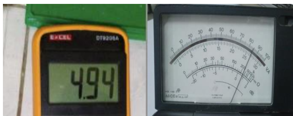
Gambar 17 Tegangan Output Relay dan Arus kumparan Relay
