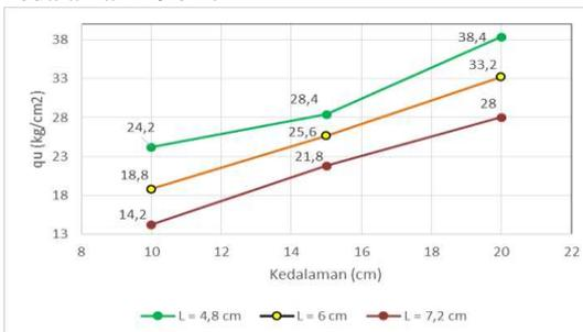
**Gambar 7.** Perbandingan Nilai Daya Dukung dengan Variasi Kedalaman
