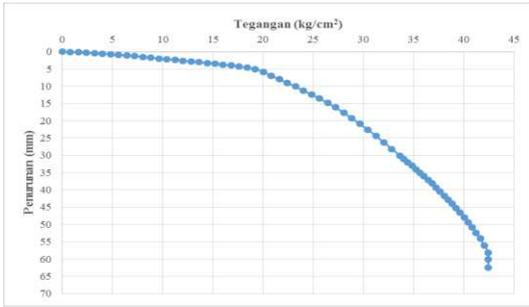
**Gambar 5.** Hubungan Tegangan dan Penurunan Tanah Stabilisasi 100%
