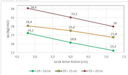
**Gambar 6.** Perbandingan Nilai Daya Dukung dengan Variasi Jarak antar Kolom
