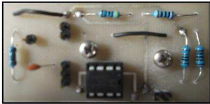
Gambar 12 Rangkaian Pengkondisi Sinyal pada Sensor Suhu PT100
