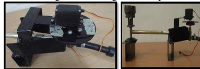
Gambar 14 Pemasangan Servo pada Valve Burner
