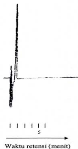
Gambar 2. Kromatogram diklorvos dengan waktu retensi 1,13 menit
