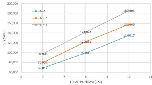
Gambar 7 Hubungan tegangan tanah ( \text{kN/m}^2 ) dan lebar pondasi (cm) dengan variasi jumlah lapis perkuatan geogrid
