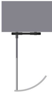
Gambar 10. Sistem mekanik pengaduk
