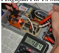
Gambar 16 Pengukuran Pin Tx Mikrokontroler
