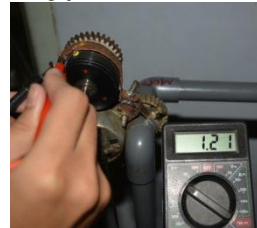
Gambar 10 Pengukuran Tegangan Modul Sensor Potensiometer \theta=90^\circ
