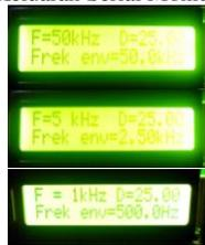
Gambar 12. Keluaran Frekuensi dan *duty cycle* pada LCD
