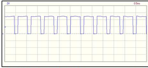
Gb. 18 Hasil Pengujian setpoint sedang menggunakan osiloskop digital
