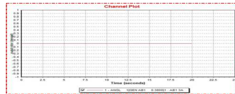
Gambar 14. Grafik sudut rotor = f(t) pada bus GEN AB1 saat diberikan gangguan pada bus LOAD 3A
