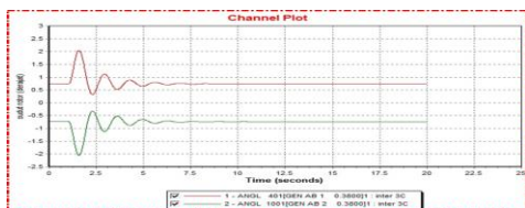
Gambar 18. Grafik sudut rotor = f(t) setelah interkoneksi pada bus GEN AB1 dan bus GEN AB2 saat diberikan gangguan pada bus load 3A Sumber : Hasil simulasi
