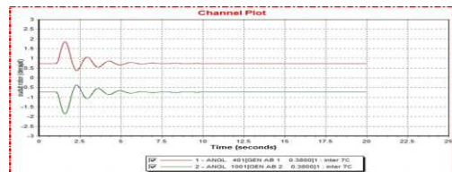
Gambar 20. Grafik sudut rotor = f(t) setelah interkoneksi pada bus GEN AB1 dan bus GEN AB2 saat diberikan gangguan pada bus load 3B Sumber : Hasil simulasi
