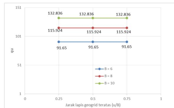
**Gambar 3.** Hubungan  $qu$  dan tegangan variasi lebar pondasi
