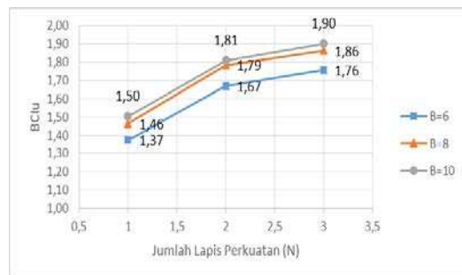
Gambar 6 Hubungan BC Iu dengan variasi Jumlah lapis Perkuatan
