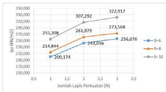
Gambar 4 Hubungan qu dengan variasi lebar pondasi
