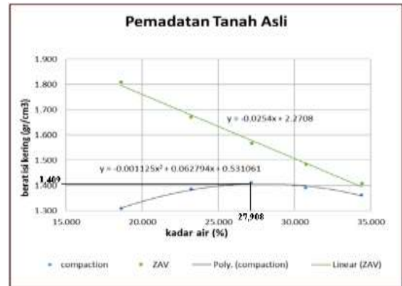
Gambar 7 Hasil Pemadatan Tanah Asli
