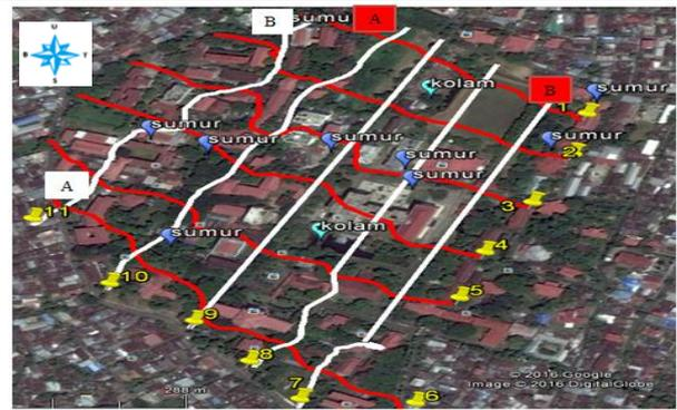
Gambar 3.1 Lintasan Pengukuran resistivitas di Unsrat
