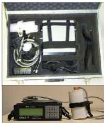
**Gambar 2.** Alat Geomagnetik GSM-19T
