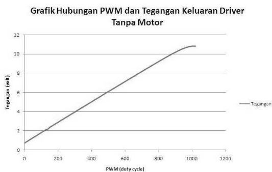
Gambar 8. Grafik PWM dan Tegangan Keluaran Driver tanpa Motor
