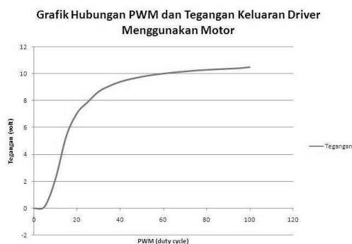
Gambar 9. Grafik PWM dan Tegangan Keluaran Driver Menggunakan Motor
