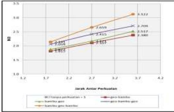
**Gambar 22** Grafik  $BCI_{(u)}$  untuk variasi jarak antar perkuatan
