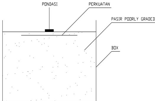
**Gambar 5** Gambar Tampak Samping Model Perkuatan
