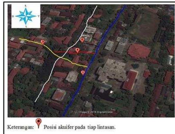
Gambar 8. Lintasan pengukuran dengan posisi lapisan pembawa air
