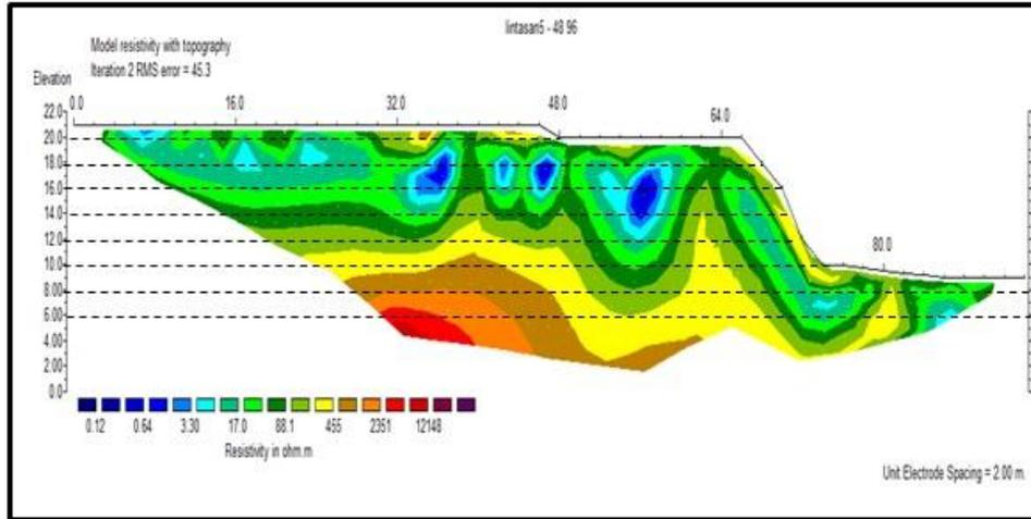
Gambar 7. Tampilan resistivitas dengan topografi lintasan 5.
