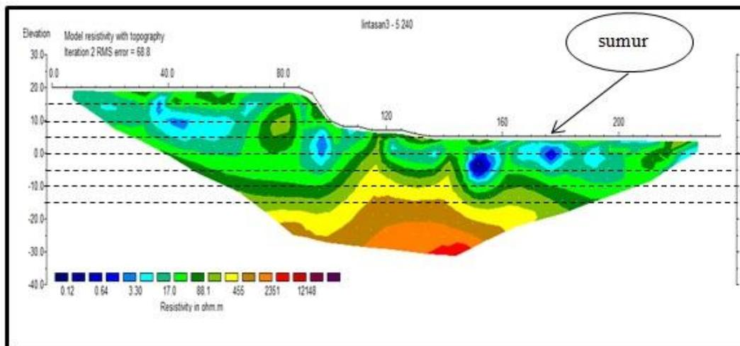
**Gambar 3.** Model resistivitas dengan topografi lintasan 1..
