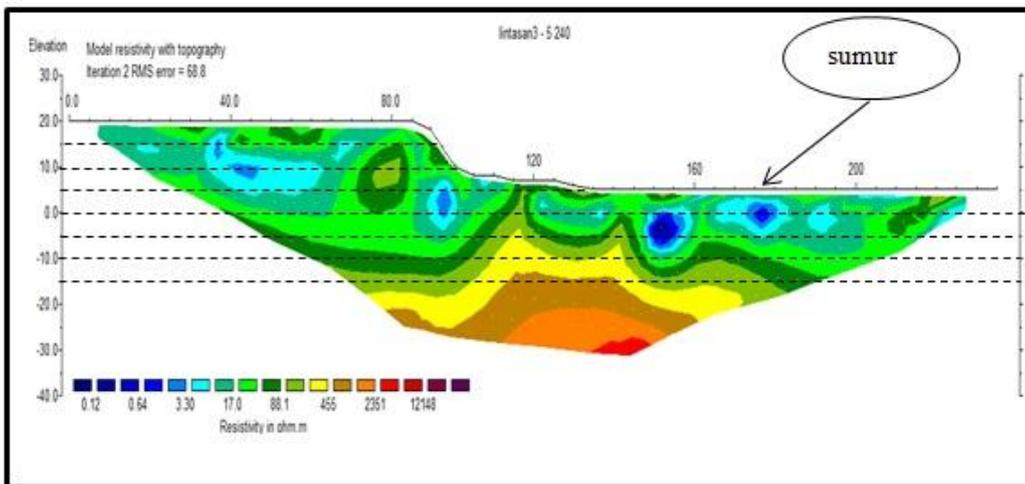
Gambar 5. Model resistivitas dengan topografi lintasan 3.
