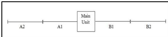
**Gambar 2.** Susunan alat pengukuran menggunakan resistivimeter.
