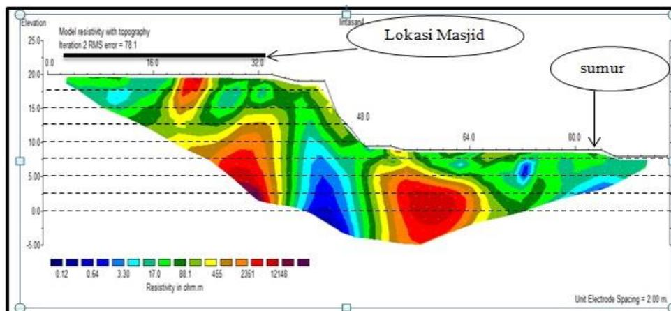
Gambar 6. Model resistivitas dengan topografi lintasan 4.
