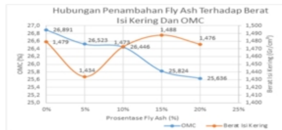
Gambar 7 Grafik Hubungan Penambahan Fly Ash terhadap Berat Isi Kering Maksimum dan Kadar Air Optimum (OMC)
