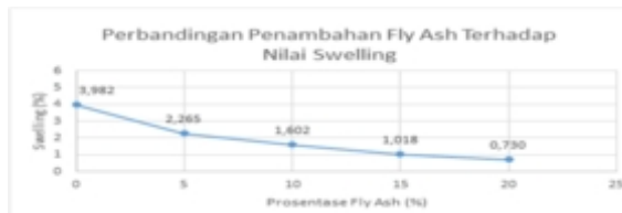
Gambar 9 Grafik Pengaruh Penambahan Kadar Fly Ash Terhadap Nilai Pengembangan ( Swelling )
