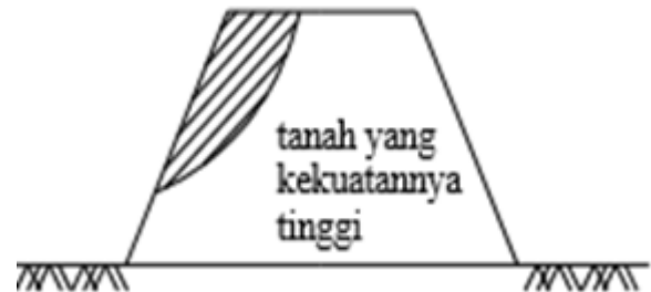
Gambar 1 Tipe keruntuhan pada lereng (Sumber: Indrawahyuni 2009)
